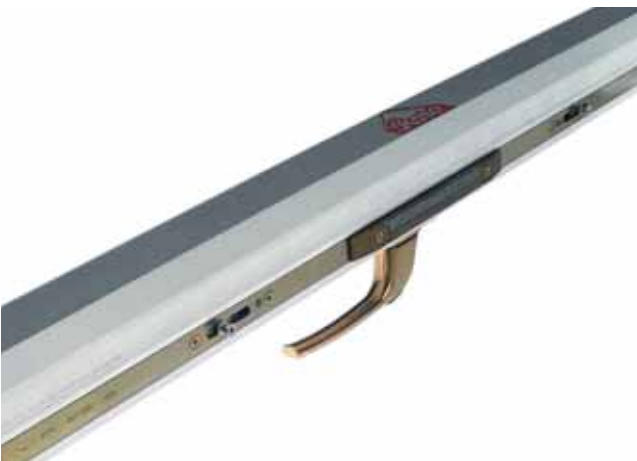
RA 2000 Getriebesystem auf der Verschlussseite. Alle Verlängerungen werden mit dem Getriebegehäuse fest verschraubt und bieten damit sicheren Schutz gegen äußere Gewalt.
