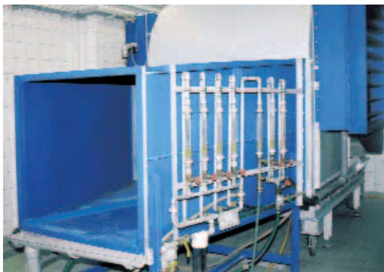
↑ TU Berlin: Versuchsstand zur Schlagregenprüfung.
