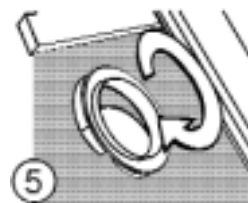
5 Anschlussring im Uhrzeigersinn eindrehen
