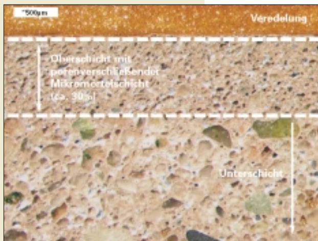
Der Schnitt durch einen Dachstein zeigt die neue Star-Oberfläche.
